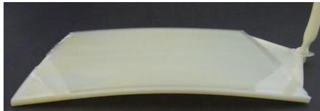
Probekörper ca. DIN A5. Kunststoff geschäumt
