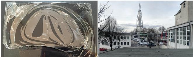
In der letzten Projektdurchführung wurden daher auch LSR (Liquid Silicone Rubber) betrachtet. Diese erlauben ein nahezu verzugsfreies, vollflächiges Hinterspritzen von Flachglas, beziehungsweise von 3D verformten Gläsern. (rechtes Bild: verzerrungsfreie Reflektion in hinterspritztem Flachglas)
